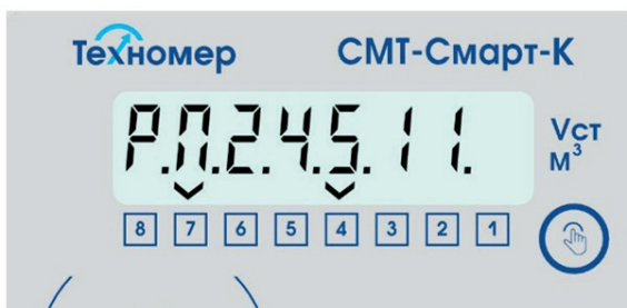
Рисунок 26 – индикация раздела «Регистр предупреждений» (зарегистрированы предупреждения П2, П4, П5, П11)
