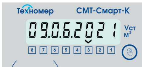
Рисунок 6 – индикация раздела «Дата прибора»
