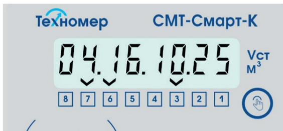
Рисунок 35 – индикация раздела «Режим передачи данных» (до следующего сеанса связи уста- новленного с сервера осталось 4 дня 16 часов 10 минут и 25 секунд)
