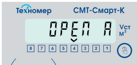
Рисунок 10 – индикация раздела «Состояние отсечного клапана» (Клапан открыт. Автоматическое управление клапаном включено)
