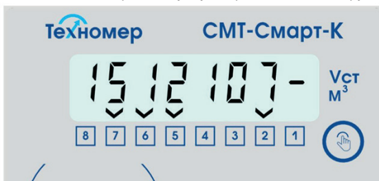
Рисунок 41 – Индикация раздела «Серийный номер. Первая часть» (сокращенный условный указатель)
