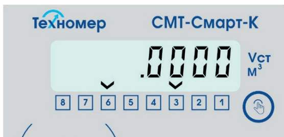
Рисунок 18 – индикация дробной части раздела «Стандартный объем газа» в технологическом меню объема
