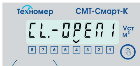
Рисунок 8 – индикация раздела «Состояние отсечного клапана» (Открытие клапана. Проверки утечки газа. Попытка №1)
