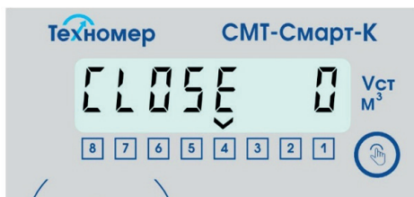
Рисунок 7 – индикация раздела «Состояние отсечного клапана» (Клапан закрыт. Код-0 – «закрыт с команды сервера»)
