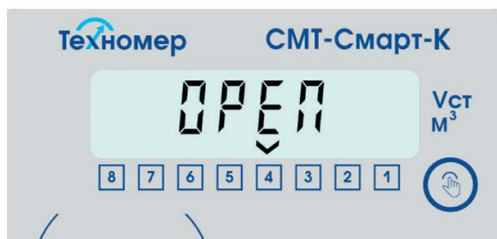
Рисунок 9 – индикация раздела «Состояние отсечного клапана» (Клапан открыт. Автоматическое управление клапаном выключено)
