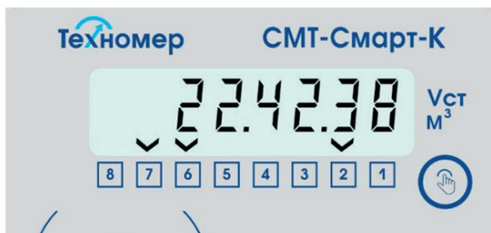
Рисунок 31 – индикация раздела «Время» (текущее время прибора 22 часа 42 минуты 38 секунд)
